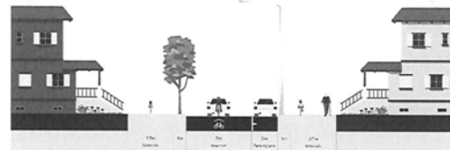
Perfil viário referente às Vias Locais de sentido único, com faixa de estacionamento de um dos lados da via e uso cicloviário compartilhado da faixa de rolamento.
