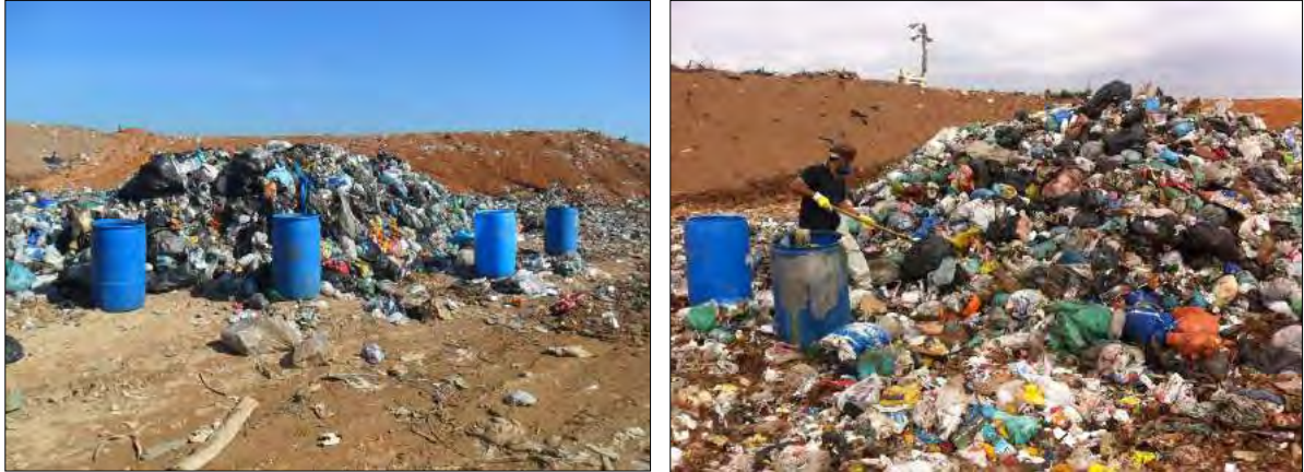
Figura 354: Quarteamento utilizando tambores de 200 litros.
